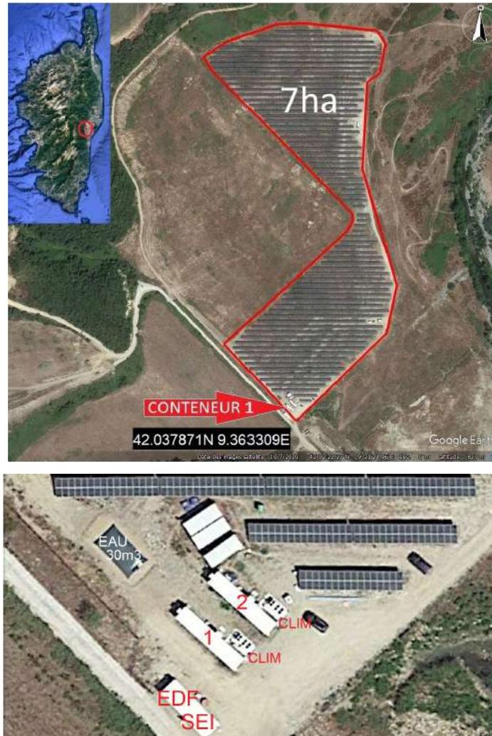
Figure 1: plan de situation de la centrale photovoltaïque de Poggio et des deux conteneurs de stockage d'énergie électrochimique
