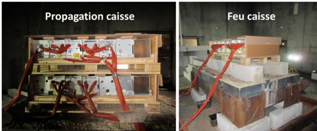
Figure 81 : Photos des montages « propagation caisse » et « feu caisse » pour les essais avec sprinklage.
