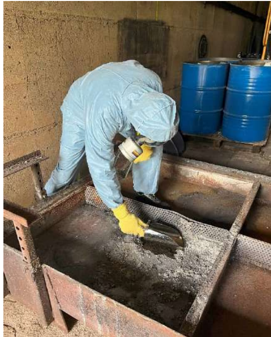
Figure 141 : Cliché photographique du prélèvement d'échantillon issu de résidus de combustion de batterie, produits à la suite d'un essai abusif
