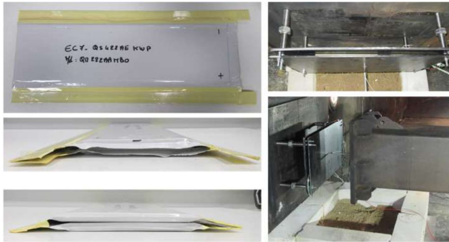
Figure 18 : Photographies de l'assemblage d'EC et du spécimen en position de test
