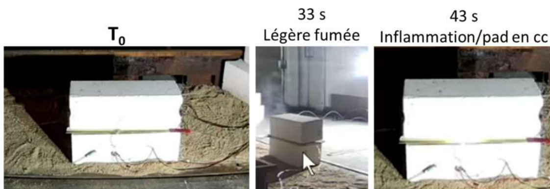
Figure 40 : Extraits vidéo de la première chauffe n'ayant pas provoqué d'emballement thermique
