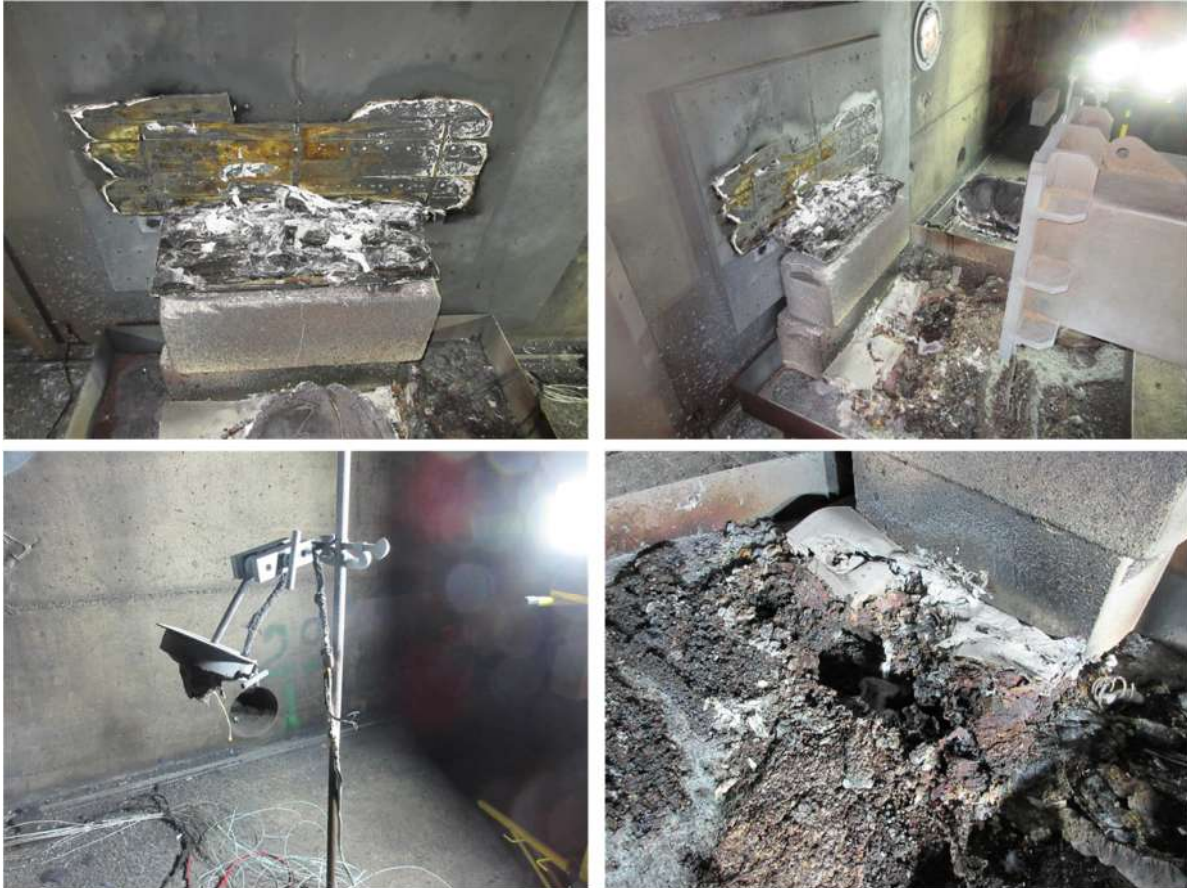
Figure 10 : Photographies après essai (écrasement axe Y)
