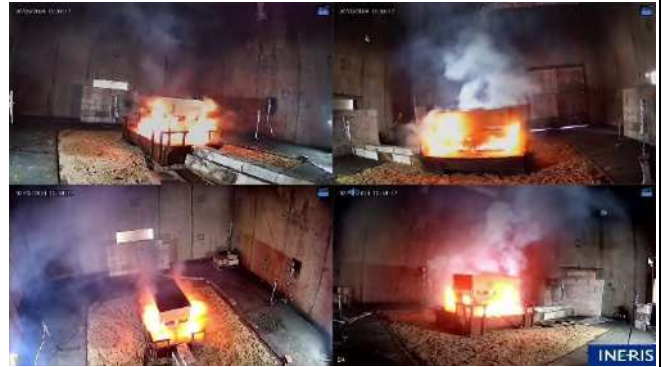
Photographie 30 : le feu gagne rapidement en intensité entretenu à l'intérieur de la caisse par la réaction du module.
