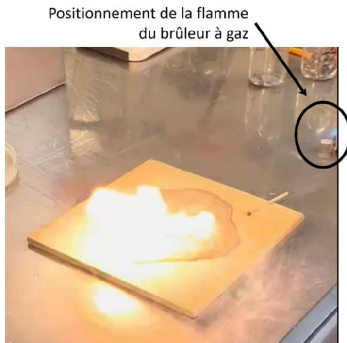
Figure 148 : Clichés photographiques de la tentative d'inflammation au brûleur à gaz des gaz générés lors de l'ajout de quelques gouttes d'eau sur l'échantillon soumis à la phase 3 de l'épreuve N.5
