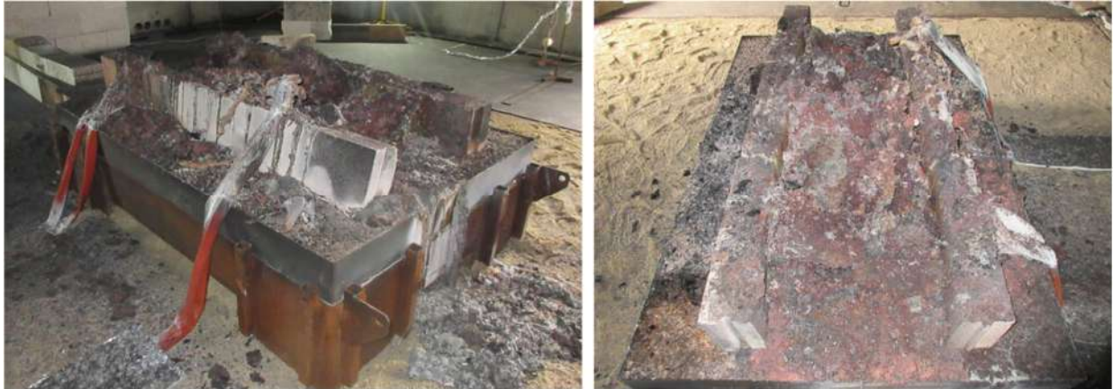
Figure 62 : Photos prises après l'essai feu caisse
