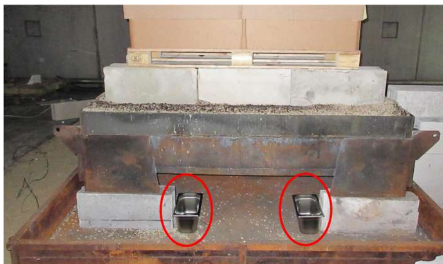
Figure 102 : Réceptacles de collecte des eaux d'extinction
