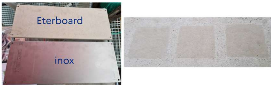
Figure 101 : Support de prélèvement des particules à proximité de l'échantillon
