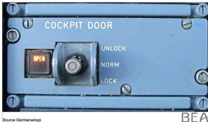
Figure 5 - interrupteur de contrôle de la porte
