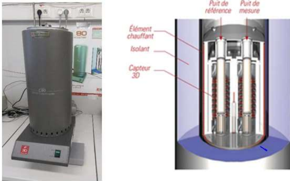
Figure 5 - Schéma et photographie du calorimètre Calvet C80
