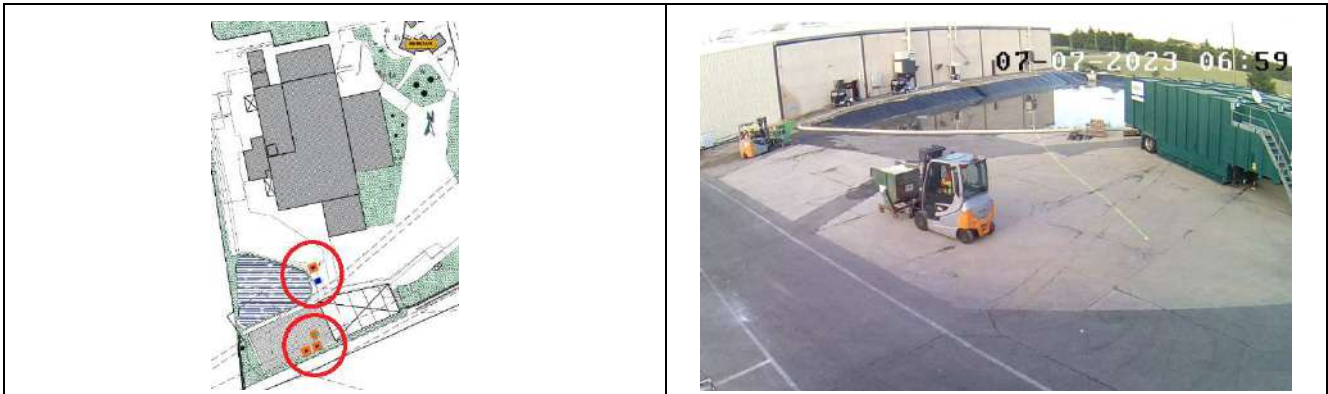
Figure 9 et photographie 27 : Vers 7h, les 2 bennes ayant réagi sont déplacées de la zone d'emballage vers le bassin, où 1 benne continue de dégazer. Les 2 bennes et les fûts situés au bâtiment D sont en décomposition et en feu.
