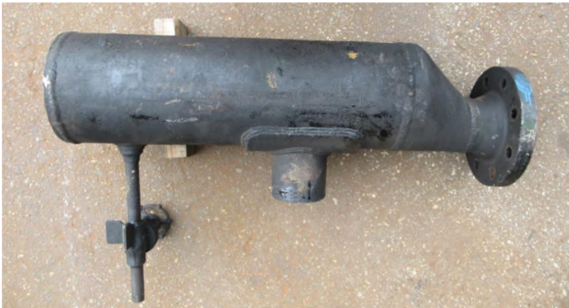
FIGURE 1 VUE D ENSEMBLE COTE DECHIRURE REPERAGE DES SOUDURES ET RELEVÉ DU DIAMETRE EXTERIEUR DU TUBE (EN mm)
