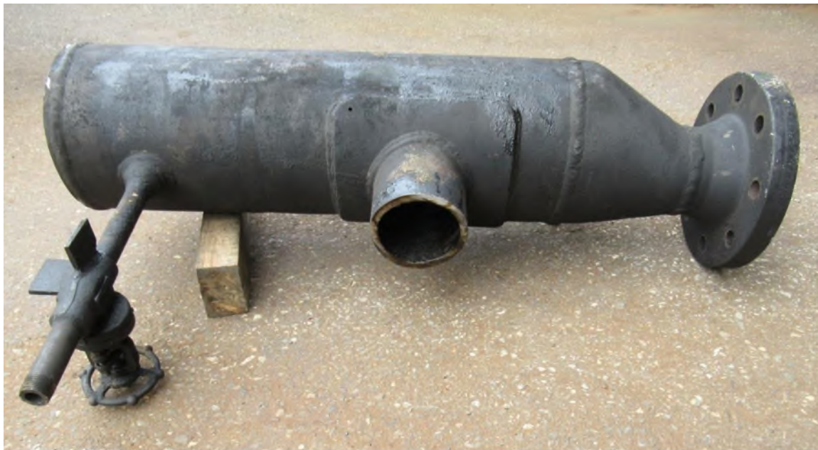
FIGURE 4 VUE D ENSEMBLE COTE GENERATRICE BASSE ET REPERAGE DES SOUDURES
