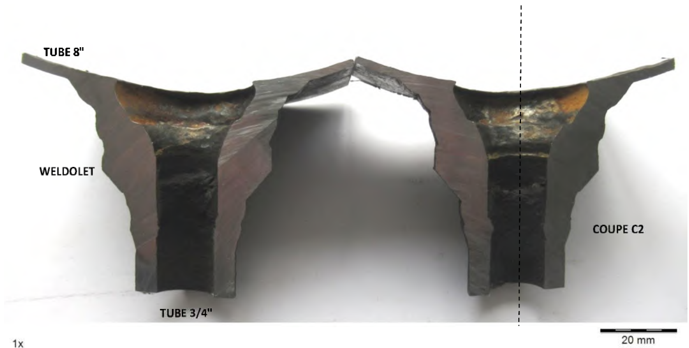
FIGURE 5 VUE D'ENSEMBLE APRES DECOUPE DIAMETRALE DU PIQUAGE 3/4"
