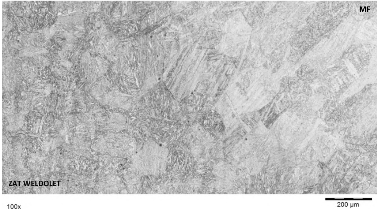
FIGURE 11 DETAIL 3 DE LA FIGURE 6 ZONE DE LIAISON COTE WELDOLET DE LA SOUDURE TUBE 8" / WELDOLET
