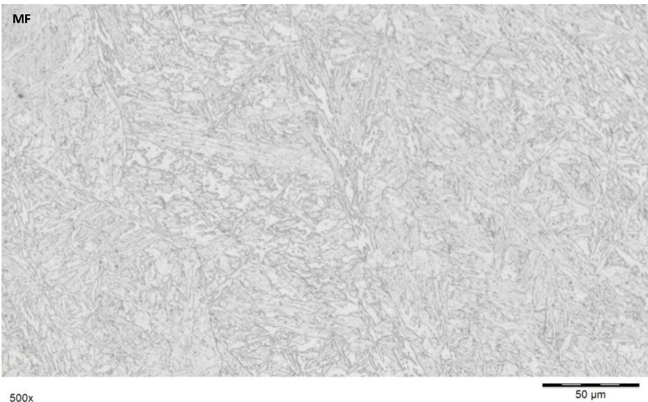
FIGURE 10 ZONE FONDUE DE LA SOUDURE TUBE 8" / WELDOLET
