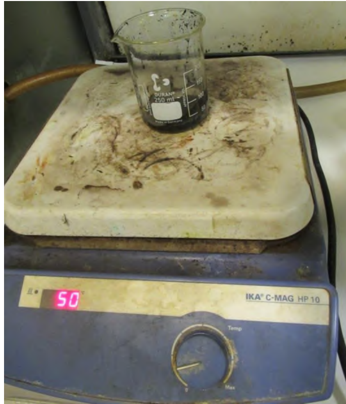
FIGURE 7 SECHAGE DU DEPOT (PENDANT 3 HEURES SUR PLAQUE CHAUFFANTE A 50°C)
