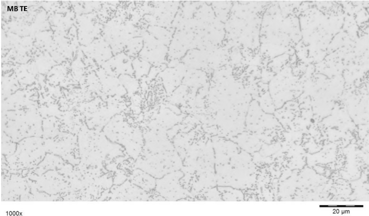
FIGURE 40 MICROSTRUCTURE A MI-EPAISSEUR DU TE
