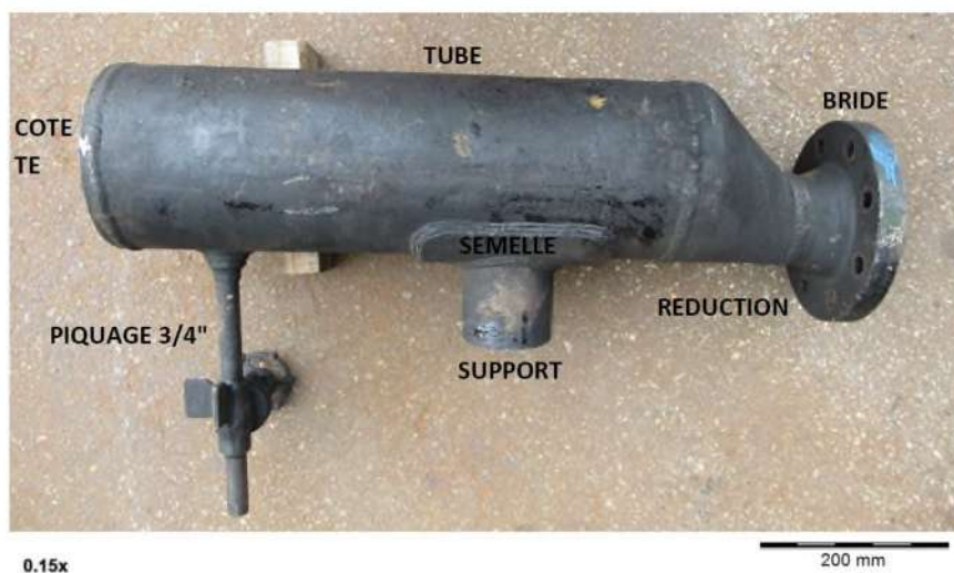
Figure n°7 : vue d'ensemble du tronçon de tuyauterie côté opposé à la déchirure (crédit Institut de Soudure)
