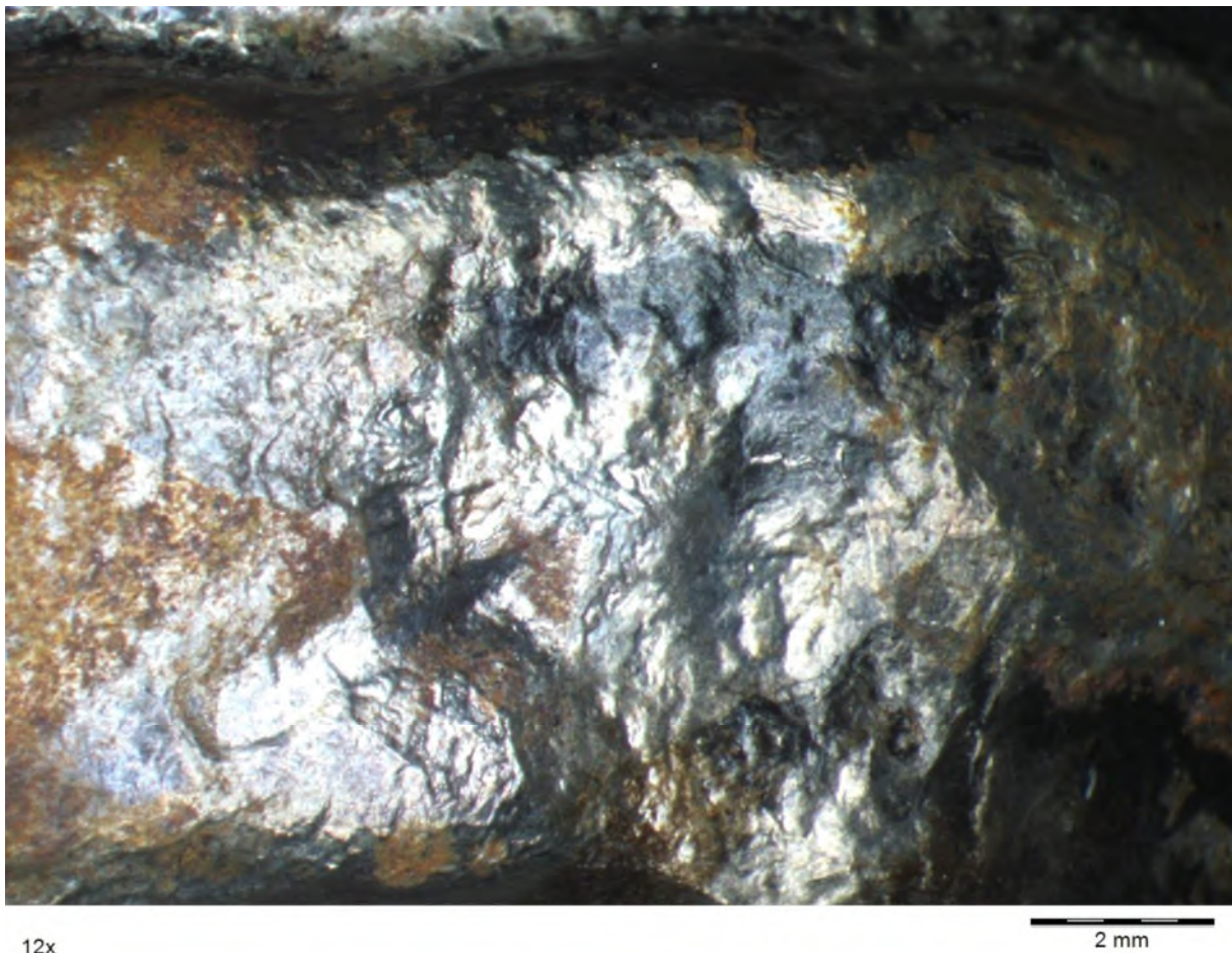
FIGURE 9 DETAIL DE LA FIGURE 8 SURFACE INTERNE DE LA SOUDURE TUBE 8" / WELDOLET
