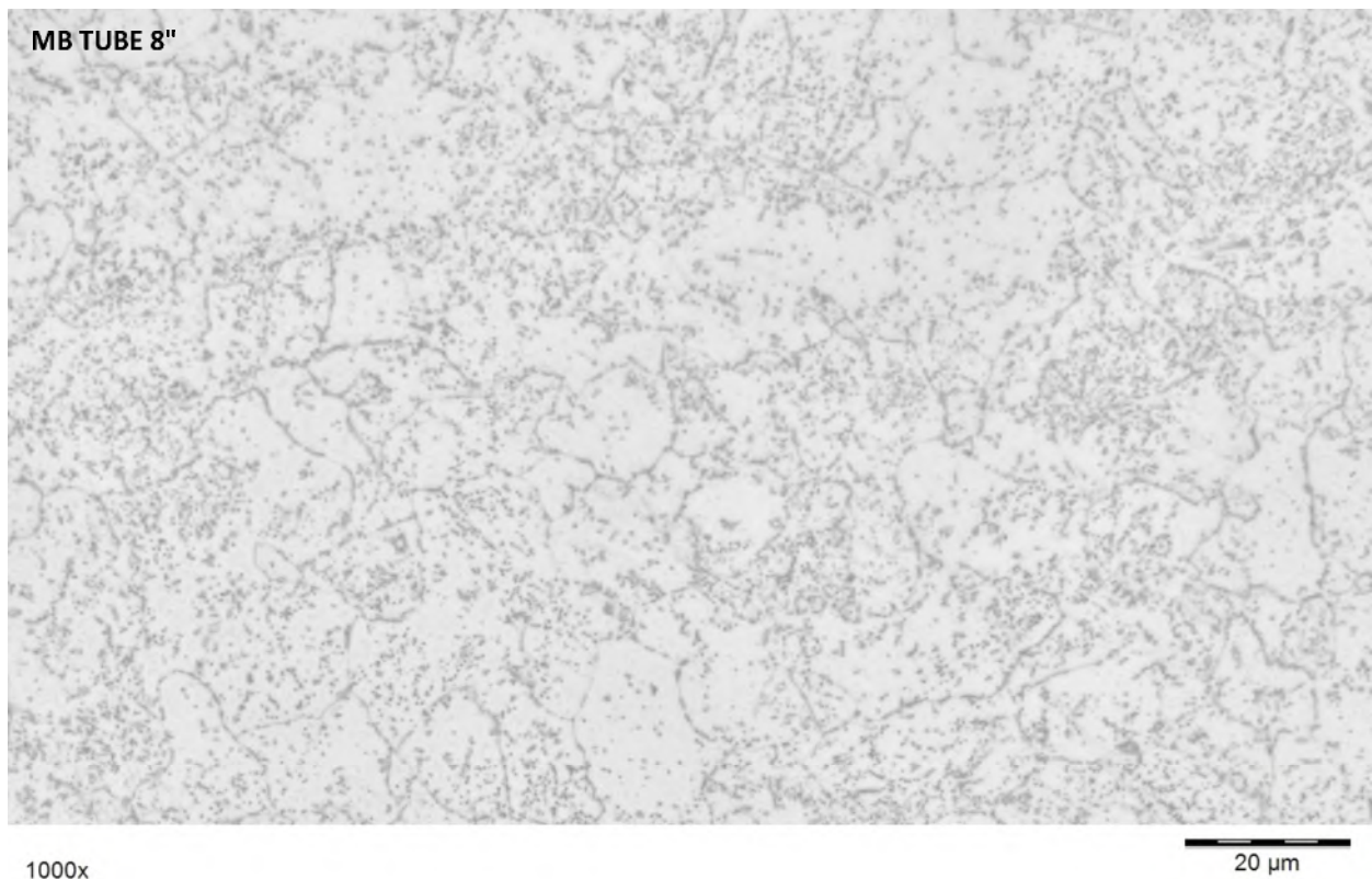
FIGURE 36 DETAIL DE LA FIGURE 34 A MI-EPAISSEUR
