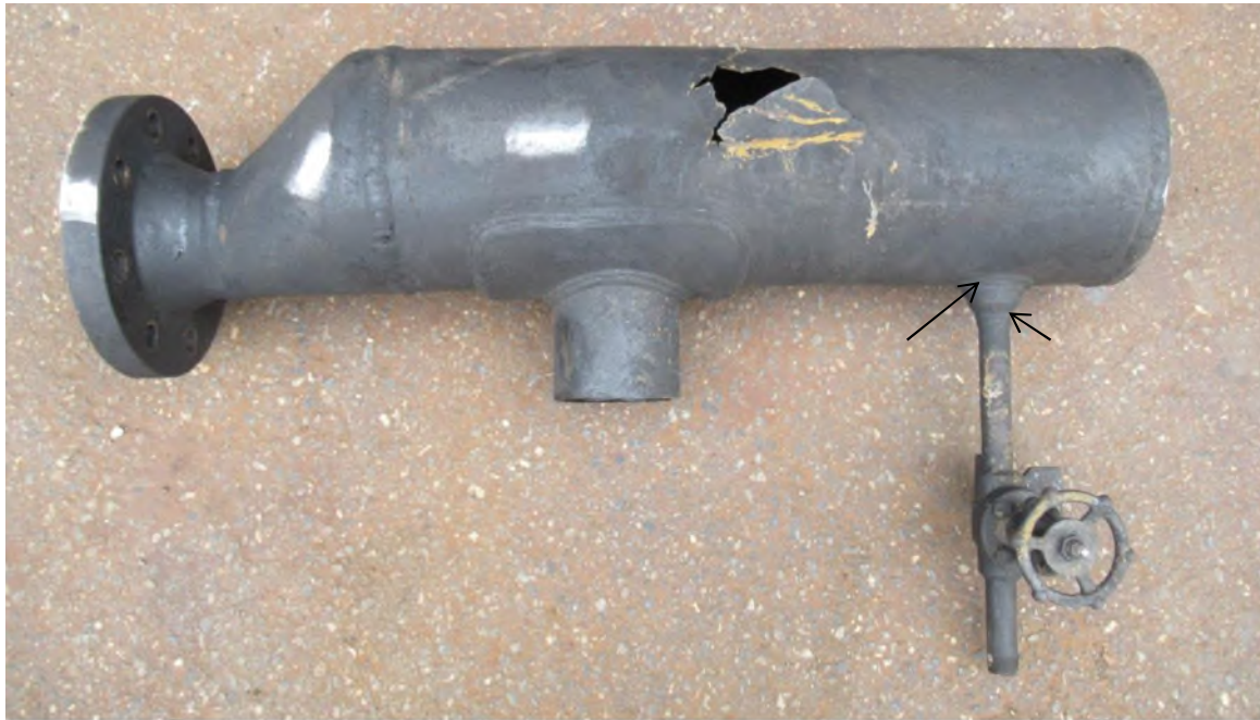
FIGURE 1 VUE D ENSEMBLE COTE DECHIRURE REPERAGE DES SOUDURES ET RELEVÉ DU DIAMETRE EXTERIEUR DU TUBE (EN mm)
