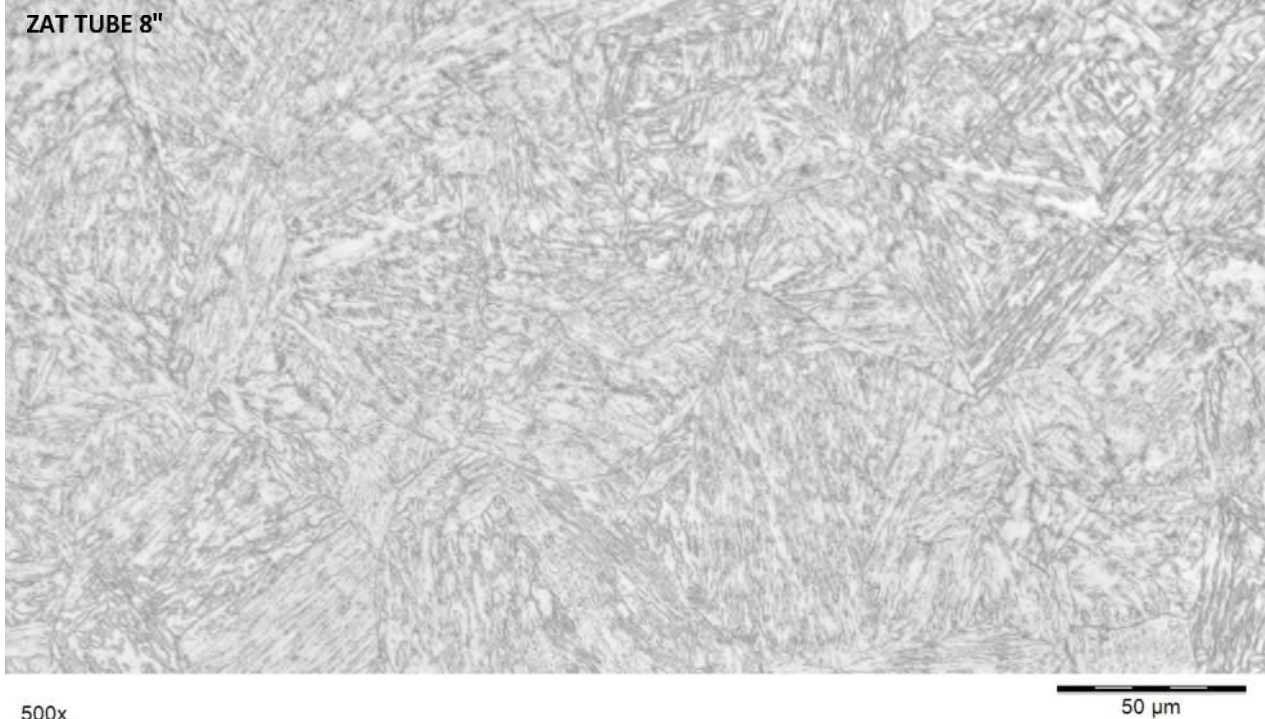
FIGURE 9 ZONE AFFECTEE THERMIQUEMENT COTE TUBE 8" DE LA SOUDURE TUBE 8" / WELDOLET
