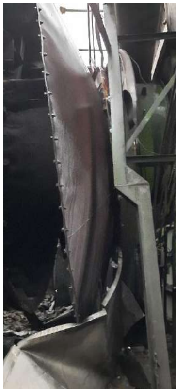
Photos n°8 et 9 : dommages constatés sur la partie du sécheur en contact avec le four (crédit INQUEST)
