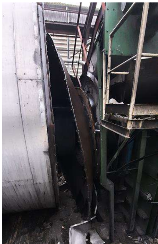
Photos n°8 et 9 : dommages constatés sur la partie du sécheur en contact avec le four (crédit INQUEST)
