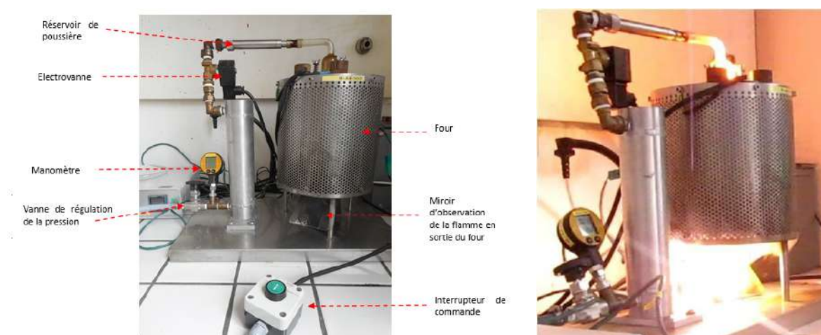
Figure B5 : Cliché photographique du four Godbert-Greenwald (à gauche) et d'une inflammation lors de l'épreuve de mesure de la TMI nuage (à droite)
