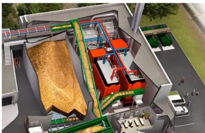
Figure 4 : Zoom sur la chaufferie biomasse, la chaudière ayant explosé est celle de droite (Source ENGIE Solutions)
